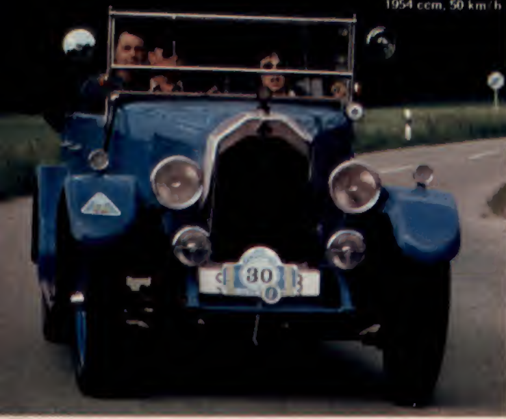
Chrysler 70 Roadster, Bau- jahr 1926, 70 PS, 6 Zylinder, 3180 ccm, 110 km/h
